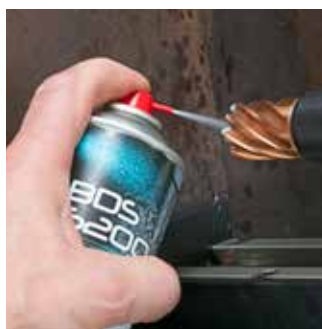
Schritt 1: Vor dem Bohrvorgang Hochleistungs-fettspray direkt in den Bohrer sprühen.
