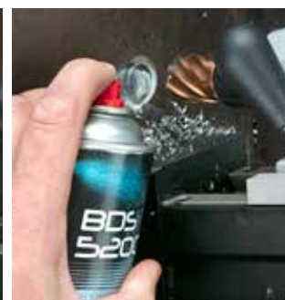
Schritt 2: Während des Bohrens Hochleistungs-fettspray auf die Bohrerspitze und in die Bohrung sprühen.
