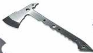
Schleifen der Rohlinge Grind the blank
